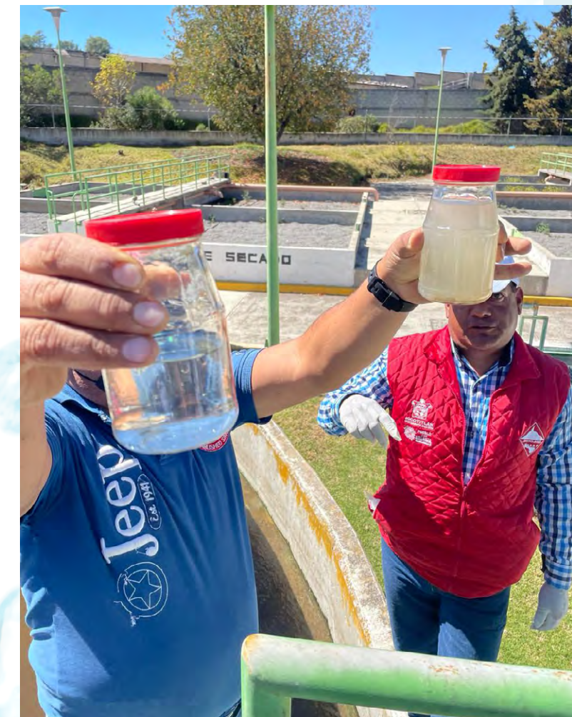
Muestras de agua al ingreso y la salida de la planta tratadora de Jocotitlán, Estado de México.
